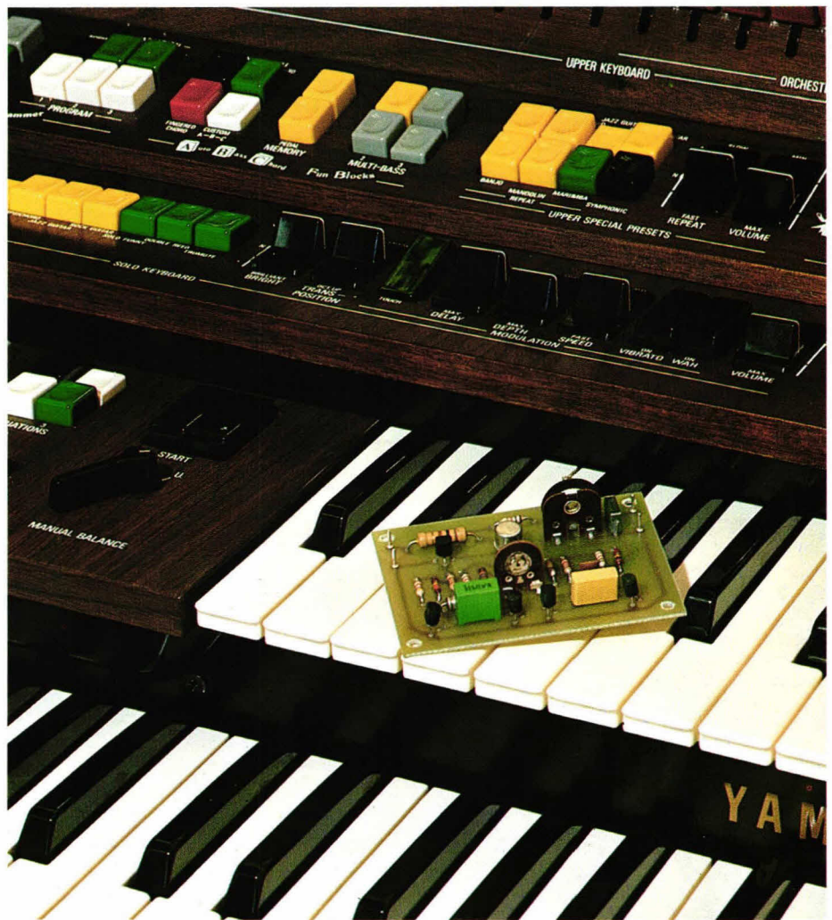
Fig. 1. Bij de luxe metronoom wordt gebruik gemaakt van 2 generatoren. Hierbij geeft generator 1 het eigenlijk tempo aan terwijl generator 2 zorgt voor een korte percussie-toon.
